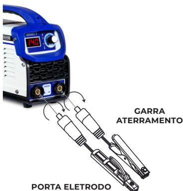
1 - Conecte o **porta eletrodo** ao pólo positivo da máquina e tenha certeza de que ao girar o mesmo esteja bem fixado. Evite mau contato.
