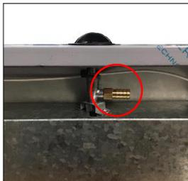
**Nunca gire o niple (peça circulada em vermelho),** isso acarreta na perda da garantia, além de criar vazamentos de gás. Lembrando que o niple possui saída lateral para conexão lateral com sua mangueira de gás. Caso você precisa de conexão frontal, deverá substituir o niple atual por um niple em formato de cotovelo.
