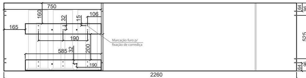
5. Divisória A_Furação Face voltada p/ Lateral Direita_2260X525X15mm
