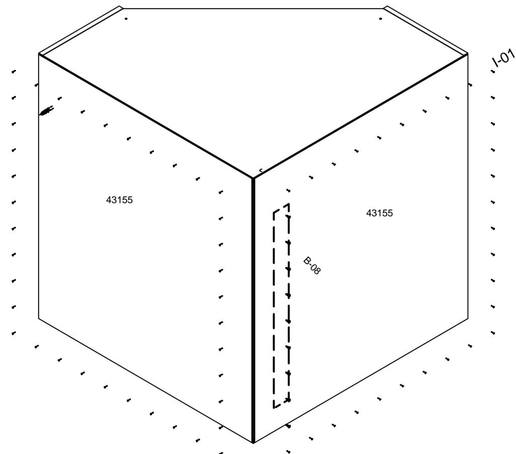
**Passo 3:** Usar dobradiças e calços para fixar portas. Usar parafusos **B-08** para fixar o puxador.
