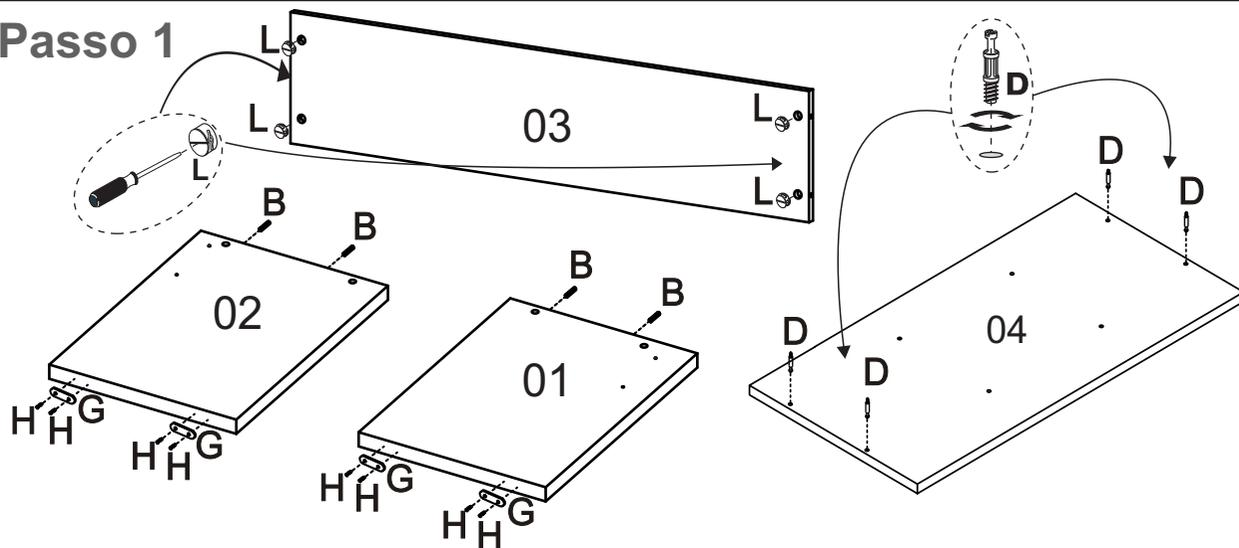
**INICIE A MONTAGEM SEPARANDO AS PEÇAS E FIXANDO OS ACESSÓRIOS**
