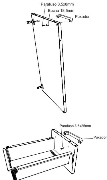
Para a fixação dos puxadores das portas utilize o parafuso 3,5x8 juntamente com as buchas 18,5mm. Para as gavetas utilize o parafuso 3,5x25, conforme indicado na imagem acima. Caso necessário realize a regulagem da porta através dos parafusos das dobradiças.
