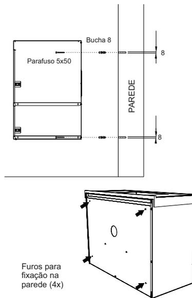
Posicione o produto na parede de forma que esteja nivelado (utilize um nível) e marque com lápis os furos na parede, passando-o pelos furos do produto. Afaste o produto da parede e com uma trena ou metro confirme se as medidas entre as marcações estão conforme os furos do produto. Fure a parede com broca n.8. Coloque a bucha 8 nos furos, posicione o produto alinhando os furos com as buchas na parede. Fixe o produto na parede com parafusos 5x50 conforme o desenho.
