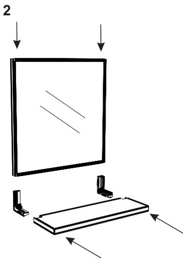
Utilize a peça plástica de ligação para encaixar a espelheira à prateleira. Com o canal do conector plástico, fazer o encaixe na quina do espelho (parte interna do encaixe), em seguida fazer o mesmo procedimento para o encaixe da prateleira no conector
