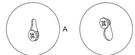
Encaixe a espelheira na parede. Posicione-a alinhando o furo maior da alheta com o parafuso fixo na parede.
