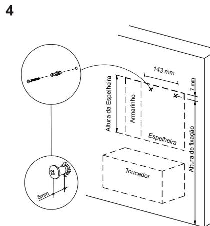
Verifique a altura de fixação em relação ao piso e marque com um lápis a altura superior e inferior da espelheira na parede.
