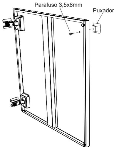
Para a fixação do puxador utilize o parafuso 3,5x8, conforme indicado na imagem acima. Caso necessário, realize a regulagem das portas através dos parafusos da dobradiça.
