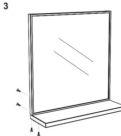
Após encaixar fixe as peças utilize os parafusos 3,5X8mm.
