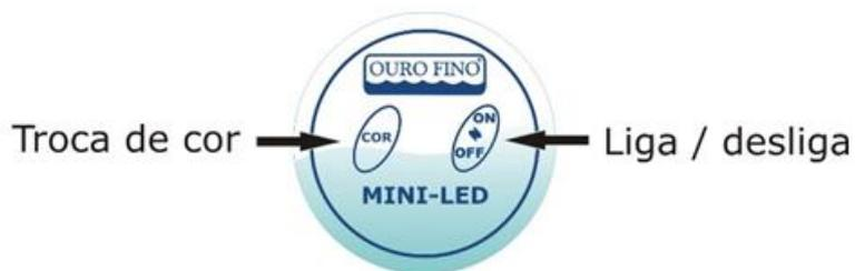
O botão de acionamento eletrônico controla o acionamento das luminárias, através dele ligamos e desligamos as luminárias e fazemos a troca dos programas de cores. Ele já sai da fábrica instalado na borda da SPA.
