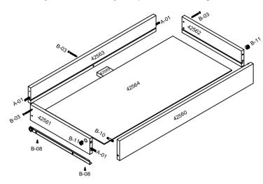
Passo 1: Usar cavilhas e parafusos B-03 para montagem da estrutura. Usar parafusos B-08 para fixar as corrediças na lateral esquerda e lateral direita. Usar pregos I-01 para fixar as sapatas M-02.
