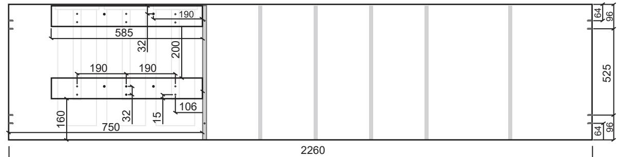
Divisória 2\_Furação Face voltada p/ Lateral Esquerda\_2260X525X15mm
