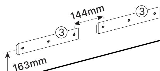
Siga as medidas desse passo para fixar os calços na parede, se caso haja mais painéis mantenha 144mm entre furos de cada calço.
