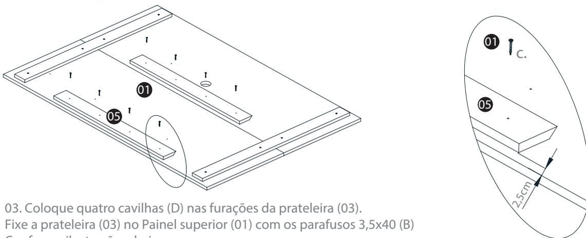
03. Coloque quatro cavilhas (D) nas furações da prateleira (03). Fixe a prateleira (03) no Painel superior (01) com os parafusos 3,5x40 (B) Conforme ilustração a baixo.
