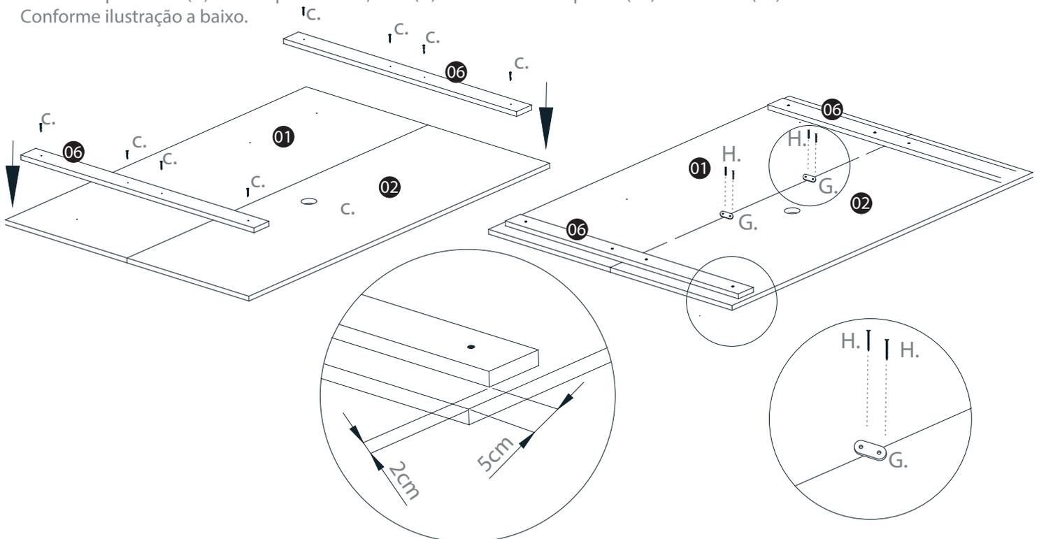
02. Posicione a Régua do Painel (05), deixando 2,5cm da borda do Painel Superior e Inferior. Fixe com os parafusos 3,5x25 (C), que acompanham o kit. Conforme ilustração a baixo.
