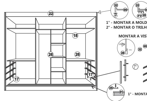
1º - MONTAR A MOLDURA (22) NO TAMPO COM PARAFUSO 3,5 X 30 (P2)
