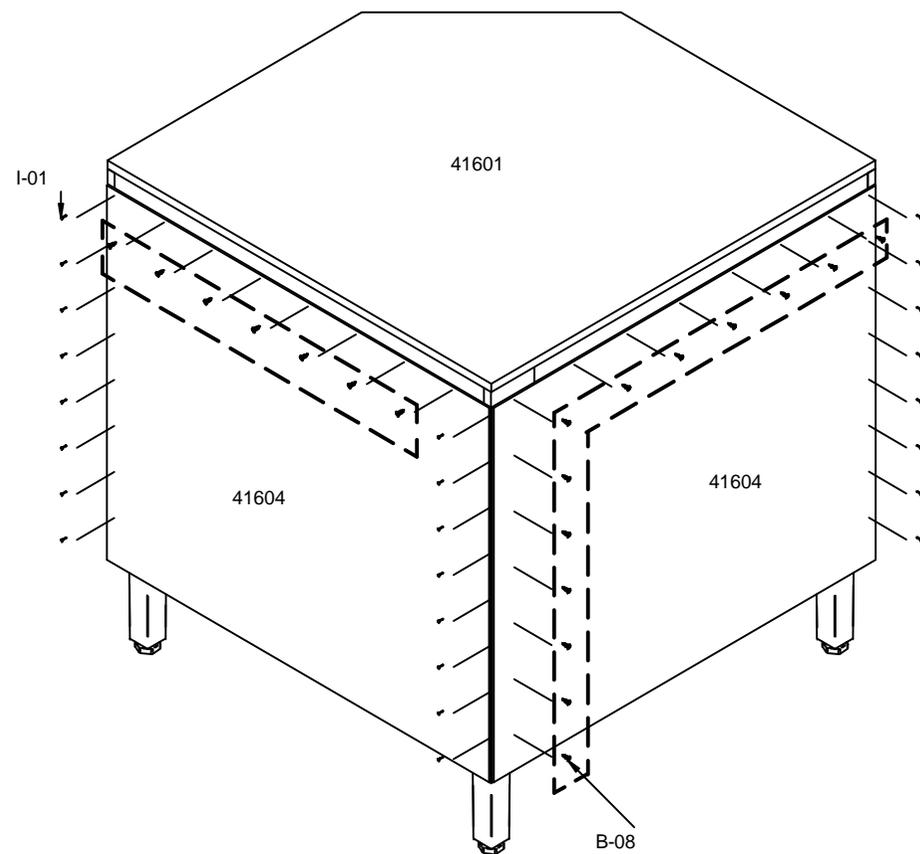
**Passo 3:** Usar dobradiças e calços para fixar a porta. Usar parafusos **B-08** para fixar o puxador.
