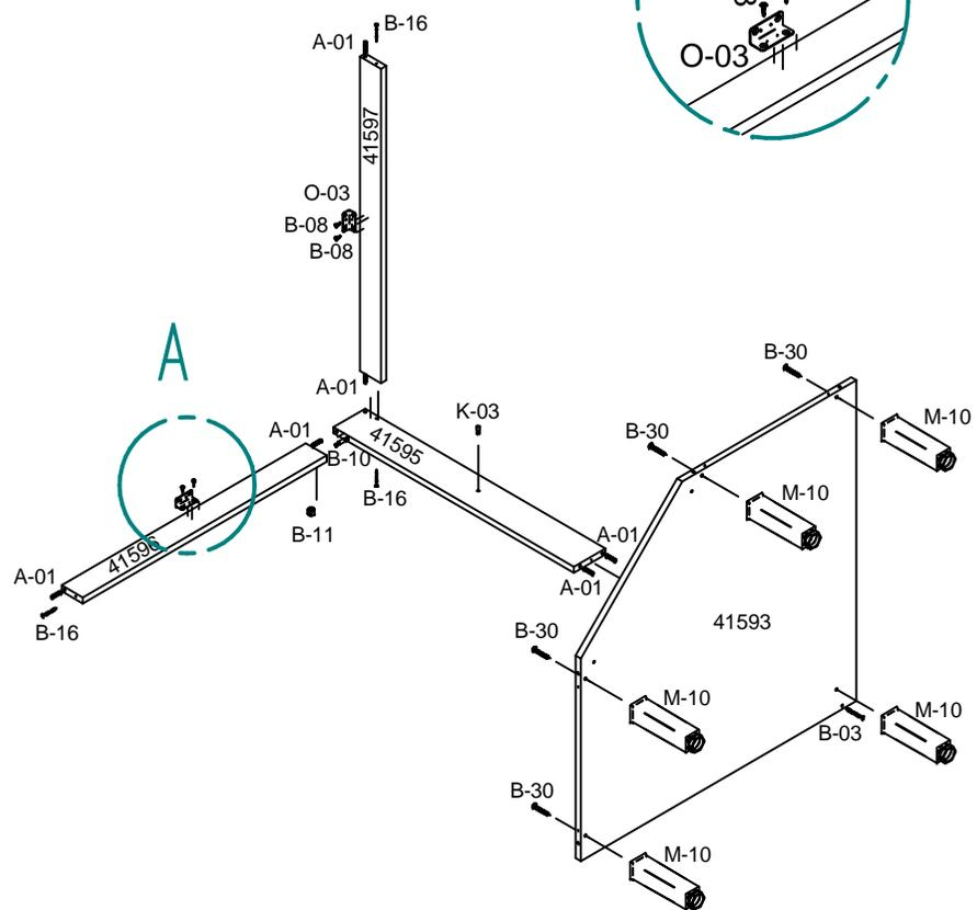
**Passo 2:** Usar cavilhas e parafusos **B-03** para unir a segunda parte da estrutura, usar parafusos **B-16** para fixar as ripas.
