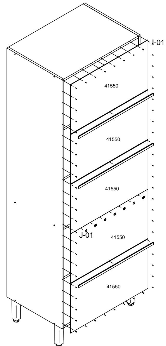
**Passo 2:** Utilizar dobradiças e calços nas portas. Utilizar parafusos **B-15** para fixar a moldura nas portas e parafusos **B-08** para fixar os puxadores.
