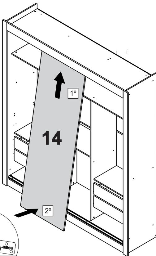
**DICA:** Devido ao desnível do piso, a porta pode apresentar diferença ao encostar na lateral externa; para resolver basta regular a roldana
