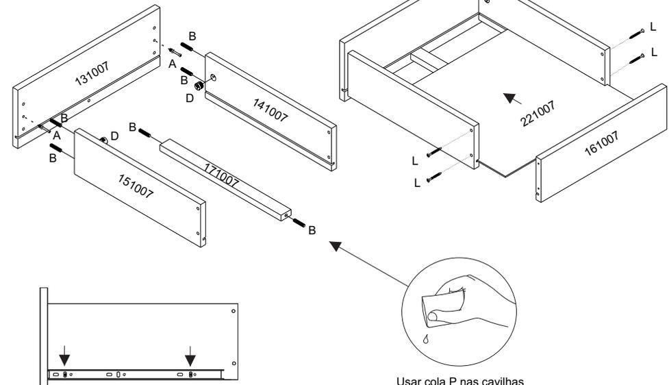
Fixação da parte móvel dos trilhos telescópico (A1762) nas gavetas com parafuso H.
