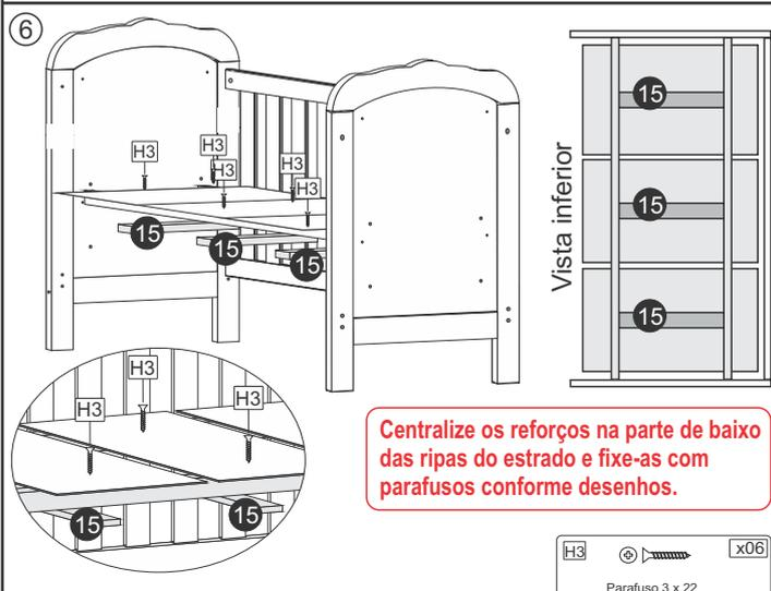
Centralize os reforços na parte de baixo das ripas do estrado e fixe-as com parafusos conforme desenhos.
