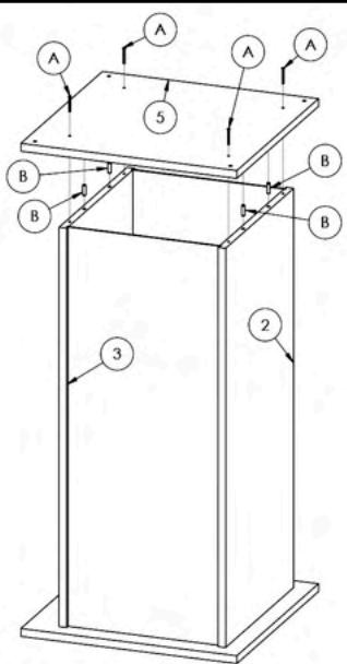
Passar Cola (D) nos furos das Cavilhas nas peças (2) e (3), fixar as Cavilhas (B) nas peças (2) e (3), fixar a peça (5) nas peças (2) e (3) utilizando os Parafusos (A) com uma Chave Phillips.
