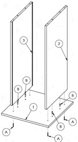
Passar Cola (D) nos furos das Cavilhas na peça (1), fixar as Cavilhas (B) na peça (1), fixar as peças (2) e (3) na peça (1) utilizando os Parafusos (A) com uma Chave Phillips.
