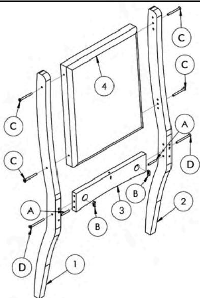
Passar Cola (F) nos furos das Cavilhas nas peças (1) e (2), fixar as Cavilhas (A) nas peças (1) e (2), fixar as peças (1) e (2) na peça (3), fixar as Porca meia lua (B) na peça (3), fixar os Parafusos (D) com uma Chave Zeta (G) nas peças (1) e (2), fixar a peça (4) com os Parafusos (C) utilizando a Chave Zeta (G) nas peças (1) e (2).
