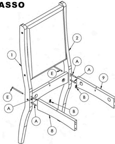
Passar Cola (F) nos furos das Cavilhas nas peças (1) e (2), fixar as Cavilhas (A) nas peças (1) e (2), fixar as peças (8) e (9) nas peças (1) e (2), fixar as Porca meia lua (B) nas peças (8) e (9), fixar os Parafusos (E) com uma Chave Zeta (G) nas peças (1) e (2).
