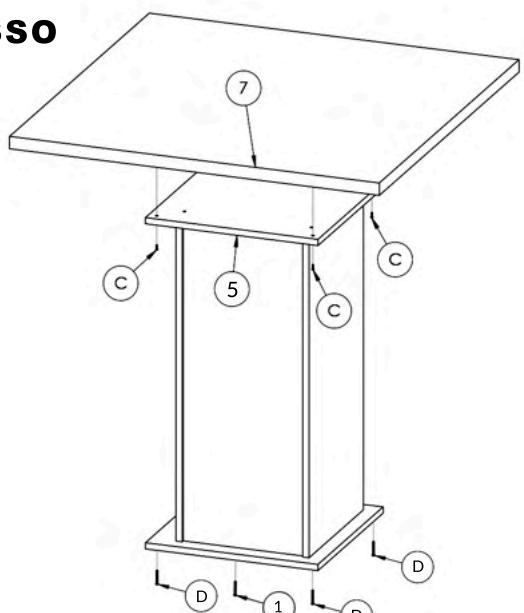
Fixar o Tampo (7) na peça (5) utilizando os Parafusos (C) com uma Chave Phillips. Fixar as Sapatas (D) na Base (1).
