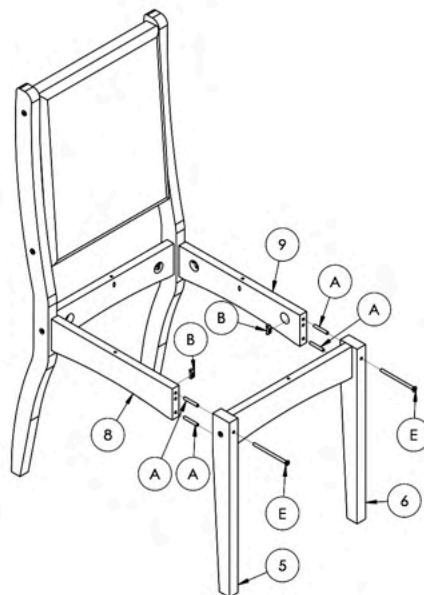
Passar Cola (F) nos furos das Cavilhas nas peças (5) e (6), fixar as Cavilhas (A) nas peças (5) e (6), fixar as peças (5) e (6) nas peças (8) e (9), fixar as Porca meia lua (B) nas peças (8) e (9), fixar os parafusos (E) com a chave Zeta (G) nas peças (5) e (6).
