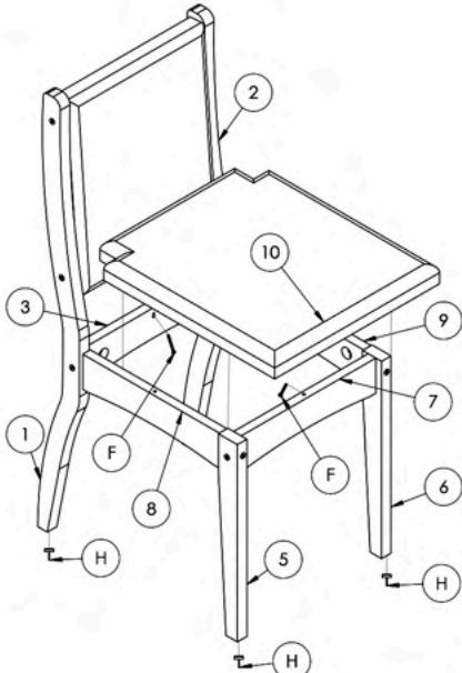
Fixar a peça (10) com os Parafusos (F) nas peças (7), (8) e (9), utilizando uma Chave Phillips, fixar as Sapatas (H) nas peças (1), (2), (5) e (6).
