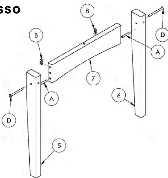
Passar cola (F) nos furos das Cavilhas nas peças (5) e (6), fixar as Cavilhas (A) nas peças (5) e (6), fixar as peças (5) e (6) na peça (7), fixar as Porca meia lua (B) na peça (7), fixar os Parafusos (D) com uma Chave Zeta (G) nas peças (5) e (6).
