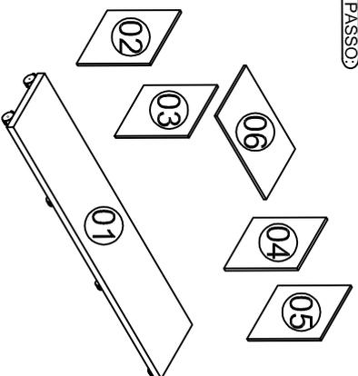
Fixar as peças nº02,03,04 e 05 na peça nº 01 com cavilhas e minifix castanha e minifix parafuso Fixar a peça nº06 nas peças 03 e 04 com cavilhas e minifix.
