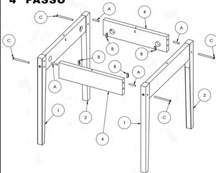
Passar a cola (G) nos furos das Cavilhas na peça (1) e (2), fixar as Cavilhas (A) nas peças (1) e (2), fixar as peças (4) nas peças (1) e (2), fixar as Porca meia Lua (B) nas peças (4), fixar os Parafusos (C) com a Chave Zeta (H) nas peças (1) e (2).
