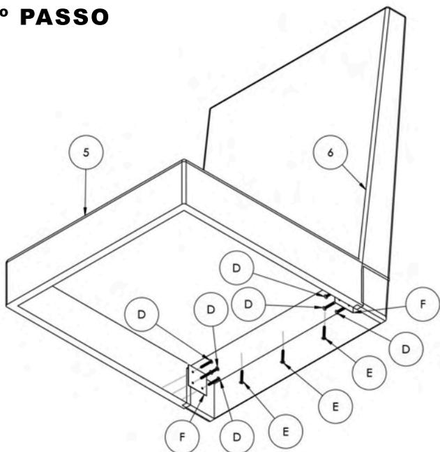
Fazer a junção do Assento (5) e do Encosto (6) utilizando o suporte (F) com os Parafusos (D) utilizando uma Chave Phillips, fixar os Parafusos (E) de baixo para cima no Encosto (6) utilizando uma Chave Phillips.
