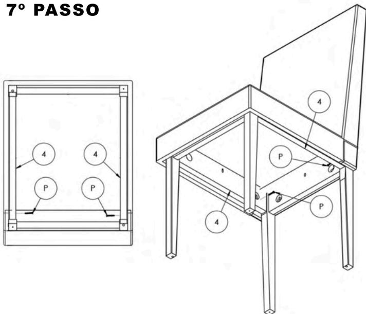
Fixar o Assento com os Parafusos (P) nas laterais (4) utilizando uma Chave Phillips.
