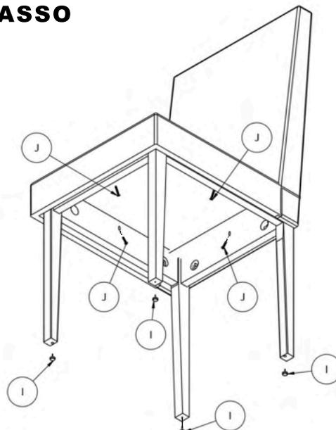
Fixar o Assento na estrutura utilizando os Parafusos (J) com uma Chave Phillips, fixar as Sapatás (I) nos pés da Cadeira.
