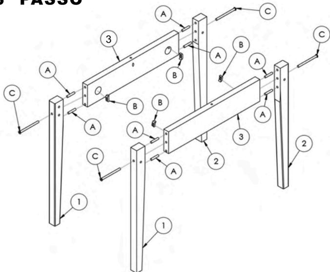
Passar Cola (G) nos furos das Cavilhas das peças (1) e (2), fixar as Cavilhas (A) nas peças (1) e (2), fixar as peças (1) e (2) nas peças (2) e (3), fixar as Porca meia Lua (B) nas peças (2) e (3), fixar os Parafusos (C) com a Chave Zeta (H) nas peças (1) e (2).
