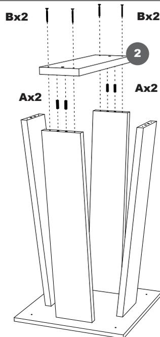
Encaixe o pé maior (2) no conjunto montado anteriormente utilizando as cavilhas (A) como guias e depois fixe a peça utilizando os parafusos 5x50 (B).
