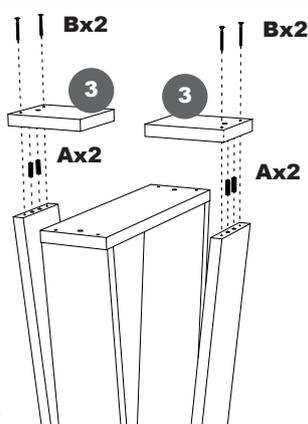
Encaixe os pés menores (3) na estrutura montada utilizando as cavilhas (A) como guias e depois fixe as peças utilizando os parafusos 5x50 (B).
