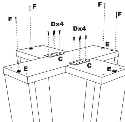
Fixe o centro da base utilizando a chapa (C) e os parafusos 3,5x14 (D). Depois, fixe as sapatas (E) utilizando os pregos 8x8 (F).
