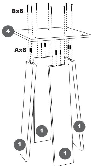
Encaixe o topo da base (4) nas laterais (1) utilizando as cavilhas (A) como guias. Depois, fixe o conjunto utilizando os parafusos 5x50 (B).
