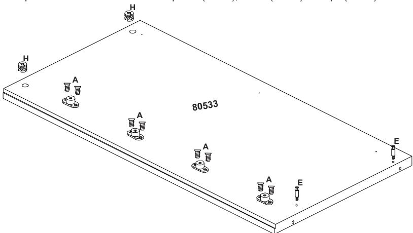
**Passo 2:** 3) Encaixar a lateral direita (80532) e esquerda (80533) na base (80529). Gire os tambores minifix 15 mm "H" para fixação. Fig. 01.
