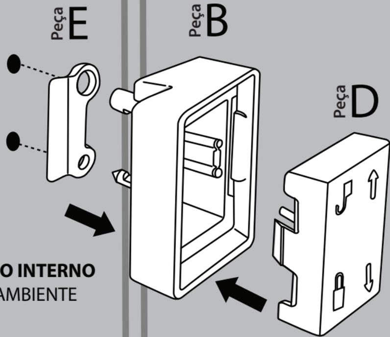
**3º Passo:** Encaixe a Peça E na Peça B (lado interno) atentando-se para a frase "LADO P/ CIMA".
