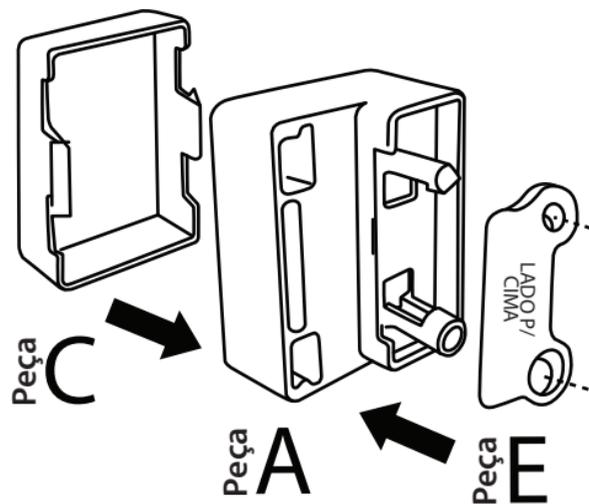
**1º Passo:** Encaixe a Peça E na Peça A (lado externo) atentando-se para a frase "LADO P/ CIMA" conforme imagem.
