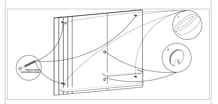
**6°** - Fixar o painel na parede com o os Parafuso cabeça chata 5x90mm phillips **I** e bucha Plastica de parede 5mm **A**. e encaixar os passa fios letra **F**.
