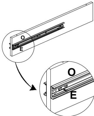
**9º** - Encaixe o fundo de gaveta nos canais das laterais, fundo e subfrente e as fixe utilizando Parafuso TP10 SXINT 5x50 s/ ponta.
