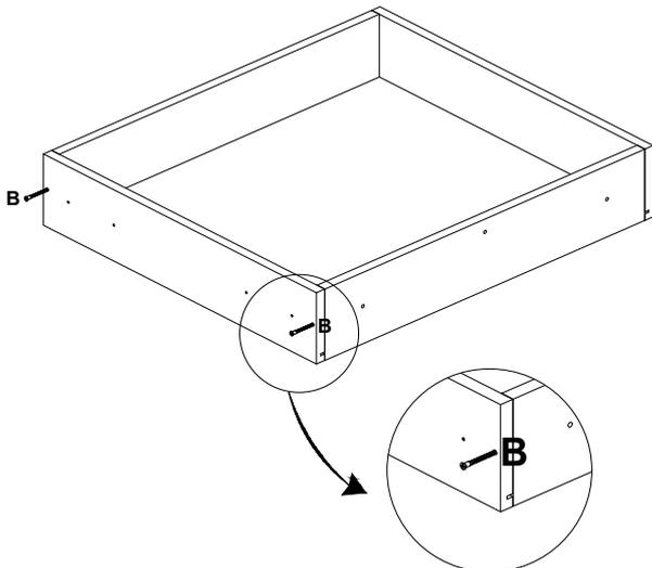
**10º** - Fixe a corrediça nas laterais utilizando o Parafuso CH PHS 3,5x14 c/ ponta. Fixe o Puxador e frente de gaveta na subfrente utilizando Parafuso CH FLANG 3,5x25 c/ ponta.
