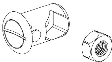
**12º** - Encaixe as buchas com as porcas nas furações da grade fixa, de modo que no momento da montagem o parafuso entre pelo lado contrário da porca, conforme desenho abaixo:
