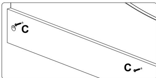
6º - Trave a base superior da barra no painel conforme a imagem ao lado utilizando o parafuso CH PHS 3,5x25 c/ ponta, fixando na cantoneira zamac 02 furos.
