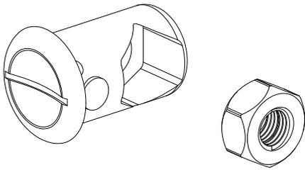
**7º** - Encaixe as buchas com as porcas nas furações da grade fixa, de modo que no momento da montagem o parafuso entre pelo lado contrário da porca, conforme desenho abaixo:
