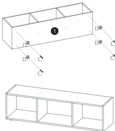
Para o uso vertical, são necessárias 4 sapatas (D) para apoiar o móvel. Para montá-las, posicione-as sobre a peça "2" e parafuse-as com parafusos 3,5x25mm (C).
