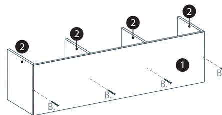
02. Insira cavilhas (A) nas peças "2", montadas no passo anterior. Após, faça o encaixe da peça "1" restante e parafuse com parafusos 3,5x40mm (B).
