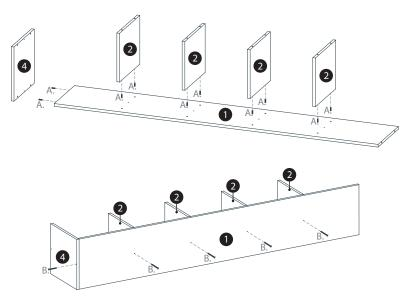
02. Insira cavilhas nas peças "2" e "4", montadas no passo anterior. Após, faça o encaixe da peça "1" restante e parafuse com parafusos 3,5x40mm (B).
