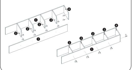
03. Insira cavilhas (A) nas peças "1" montadas nos passos anteriores. Após, encaixe a peça "4" restante e parafuse com parafusos 3,5x40mm (B).
