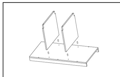
Pegue a base fixada com parafusos e junte as divisórias. Utilizando o sache de cola (I) prenda com cavilhas (A) as divisórias internas (F) conforme imagem acima.
