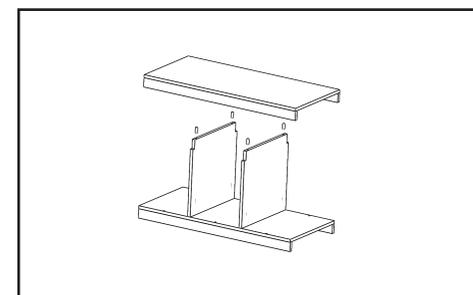
Pegue a peça anterior e junte com o tampo com testeiras. Utilizando o sache de cola (I) prenda com cavilhas (A) as divisórias internas (F) conforme imagem acima.
