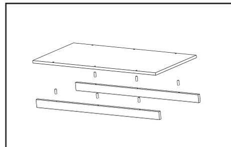
Separe as base (E) e testeiras (D). Utilizando o sache de cola (I) prenda as cavilhas (A) conforme imagem acima. Esta peça sera a parte superior.
