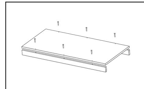
Utilizando os Parafusos (B) fixe a base (E) com as testeiras(D) já com parafusos (B), esta peça será a base de montagem.
