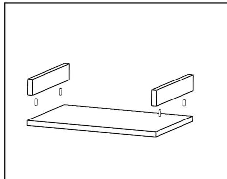
Separe as bases (E) e testeiras (D). Utilizando o sache de cola (H) prenda as cavilhas (A) conforme imagem acima.
