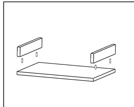
Separe as bases (E) e testeiras (D). Utilizando o sache de cola (H) prenda as cavilhas (A) conforme imagem acima.
