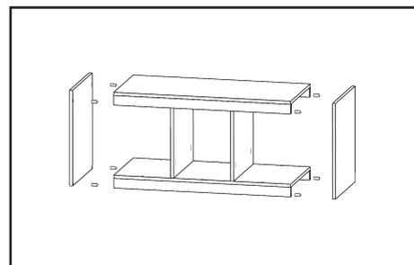
Pegue a peça anterior. Utilizando o sache de cola (I) prenda com cavilhas (A) as laterais (G) conforme imagem acima.
