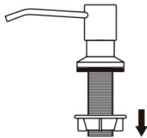
**2-** Insira o tubo do pump no sistema pump, por dentro da rosca, e passe pela bancada.
