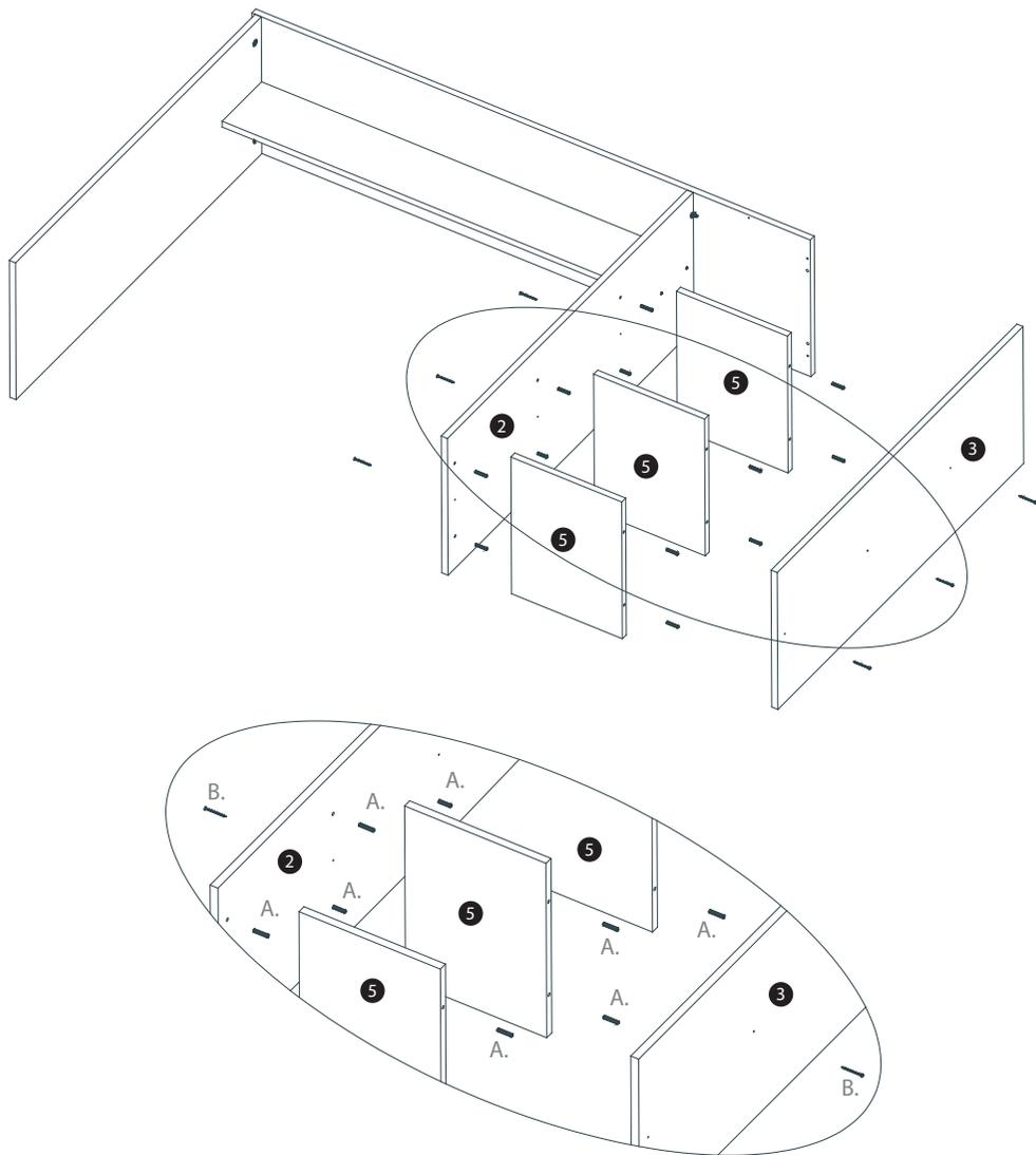
03. Monte as peças (6,7,8,10) com Cavilhas (A) e Parafusos 3,5x40 (B). Após, encaixe as Cavilhas (A) nas furações superiores do Tampo (4). Fixe as duas estruturas com dois Parafusos 3,5x40 (B).
