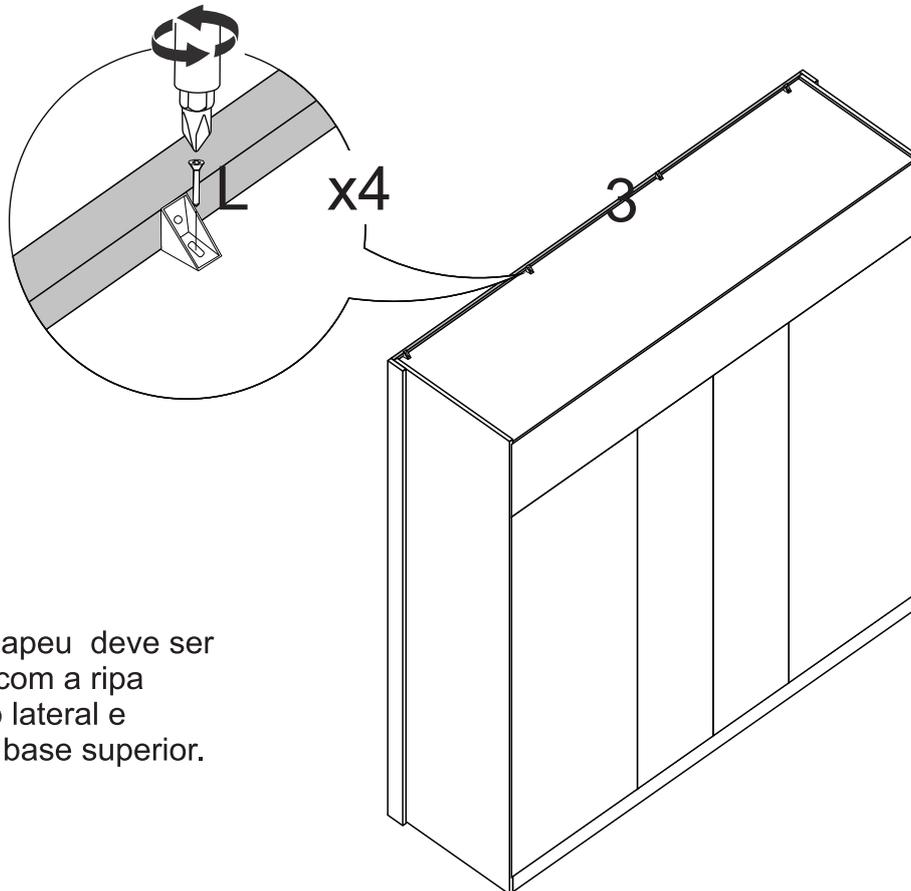
Obs: o chapéu deve ser alinhado com a ripa envoltório lateral e fixado na base superior.
