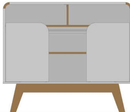
\* 770 x 900 x 360mm: medidas nominais de Altura x Largura x Profundidade do produto montado, incluindo os pés.
