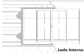
Preencher com argamassa reforçada (areia e cimento 3/1) ao redor da esquadria e no local de todas as grapas, não deixando espaços vazios. Ao rebocar a parede evite respingar na esquadria, caso isso ocorra, limpe rapidamente com pano úmido.
