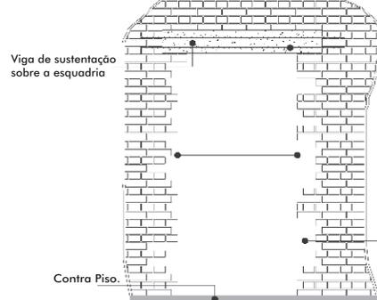
Para atender a NBR 10.821 esse produto deve ser instalado em área coberta, pois não são realizados testes de estanqueidade. Calcule corretamente o espaço para a porta não raspar no piso acabado.
