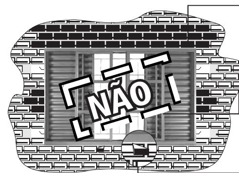
**Nunca assente tijolos diretamente sobre a janela ou pressione com pedaços de tijolos os perfis da janela quando estiver colocando a massa para fixação. Isto pode empenar as guias (superior/inferior) e travar as folhas móveis.**
