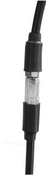
Após o ajuste, aperte a porca de bloqueio com segurança. Em seguida, ligue o motor e verifique se há uma operação adequada da alavanca de embreagem.
