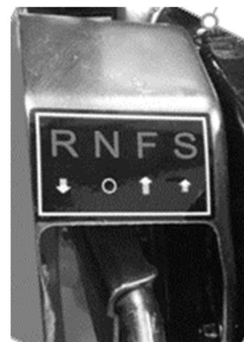
**NOTA:** Se a alavanca de câmbio não engatar a marcha desejada, aperte a alavanca de embreagem e mova o equipamento ligeiramente para reposicionar as engrenagens.
