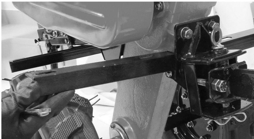
Parafuse os 3 suportes ao equipamento sem apertar os parafusos, em seguida encaixe os paralamas sob o suporte colocando todos os parafusos e porcas.
