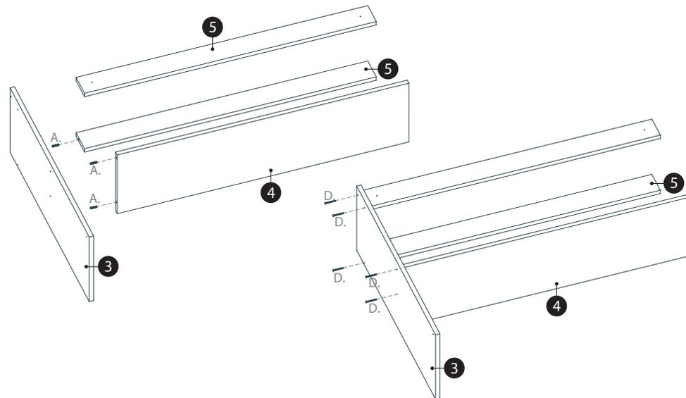
02. Faça a identificação da lateral esquerda (3). Faça o encaixe de cavilhas (A) nas peças "5" e "4", montadas no passo anterior e encaixe a lateral (3) à estrutura. Faça a fixação das partes com parafusos 3,5x40mm (D), de fora para dentro.
