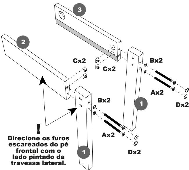
Coloque as arruelas de pressão (B) nos parafusos 1/4x80 (A) e fixe os pés frontais (1) nas travessas laterais (2 e 3) utilizando as porcas meia-lua (C). Depois, cubra os parafusos com a tampa do parafuso 1/4(D).
