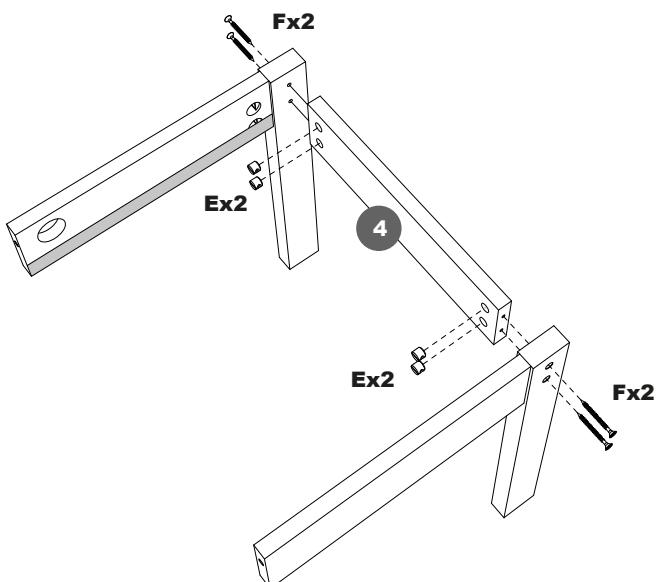
Utilize as porcas cilíndricas (E) com os parafusos 5x50 (F) para fixar os conjuntos montados anteriormente na travessa inferior (4).
