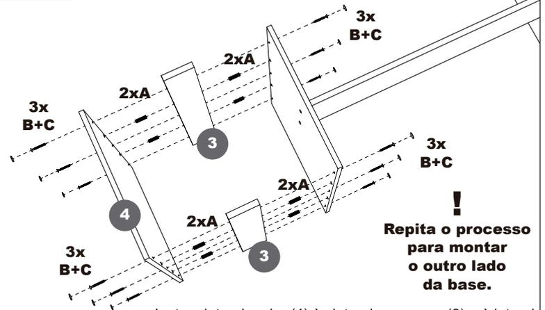
Junte a lateral maior (4) às laterais menores (3) e à lateral maior da travessa (2) utilizando as cavilhas (A) como auxílio. Fixe tudo utilizando os parafusos 5x50 (B) e tampe-s utilizando os tapa-furos (C).
