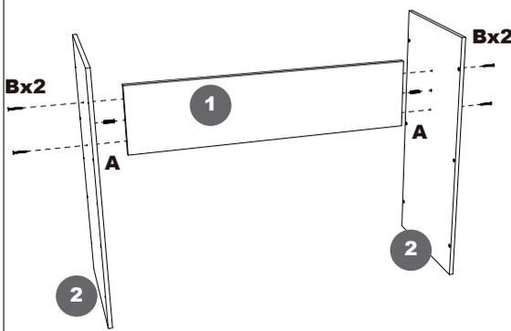
Junte a travessa (1) e as laterais maiores da travessa (2) e fixe-as utilizando os parafusos 5x40 (B).
