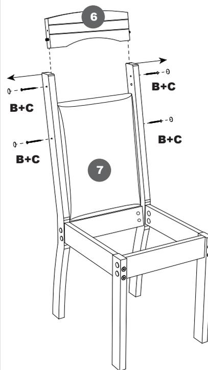
Abra levemente as laterais da cadeira para encaixar o encosto (7) e a travessa superior do encosto (6). Depois fixe-as utilizando os parafusos 5x50 (B) e cubra-os utilizando os tapa-furos (C).
