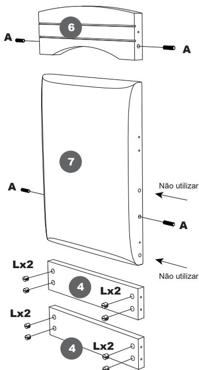
Encaixe as cavilhas (A) e as porcas cilíndricas (L) nos locais indicados.
