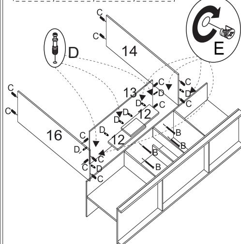
MONTE O TAMPO TV, LATERAL SUPERIOR ESQUERDA, LATERAL SUPERIOR DIREITA E APOIO DO TAMPO TV.
