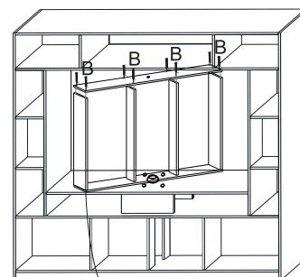
COM AS PEÇAS 24 E 25 INSTALADAS NO MÓVEL, INICIE A MONTAGEM DO NICHO, UNINDO AS PEÇAS 23 E 26.
