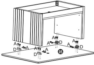
Forrar piso com papelão para não danificar produto. parafusar cantoneiras **D** seguindo marcação no tampo **5**. Centralizar mesa sobre tampo **5** e parafusar cantoneira **D** nas laterais internas **2**.
