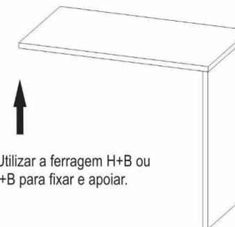
Utilizar a ferragem H+B ou I+B para fixar e apoiar.
