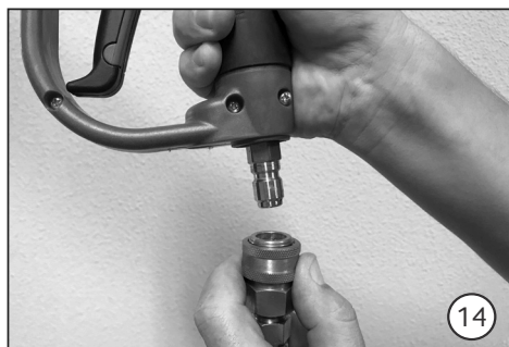
14. Conecte a mangueira de alta pressão na pistola, puxando a trava do engate rápido.
