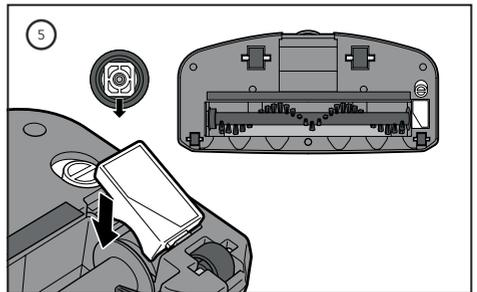
5. Recoloque a escova giratória conforme a posição indicada, certifique-se de que ela se encaixa corretamente em seu local respectivo e de que está girando livremente.
