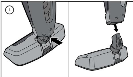
1. Para desmontar o bico múltiplo da base vertical articulada pressione o botão e em seguida, remova-o.
