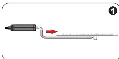
Encaixar a resistência passando pelo suporte da grelha;
