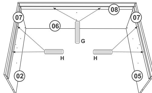
Fixar as peças 07 nas peças 02 e 05 com Cavilha 6x20. Fixar a peça 08 na peça 06 com Cavilha 6x30.
