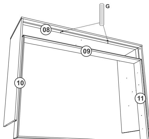
Fixar a peça 09 na peça 08 com Cavilha 6x30.
