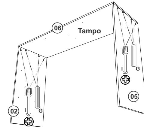
Fixar as peças 02 e 05 na peça 06 com Cavilha 6X30 e Minifix.
