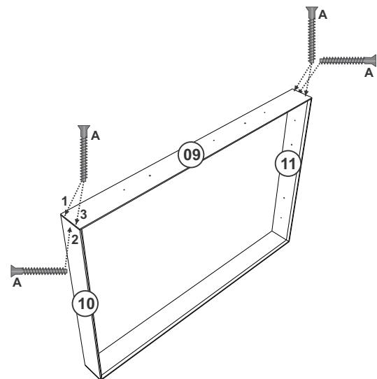
Fixar a peça 09 nas peças 10 e 11 com Parafuso 5x40.
