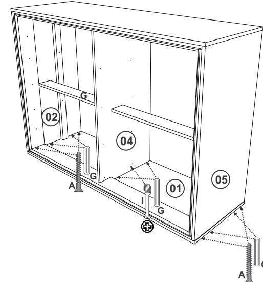
Fixar a peça 01 nas peças 02 e 05 com Cavilha 6x30 e Parafuso 5x40
