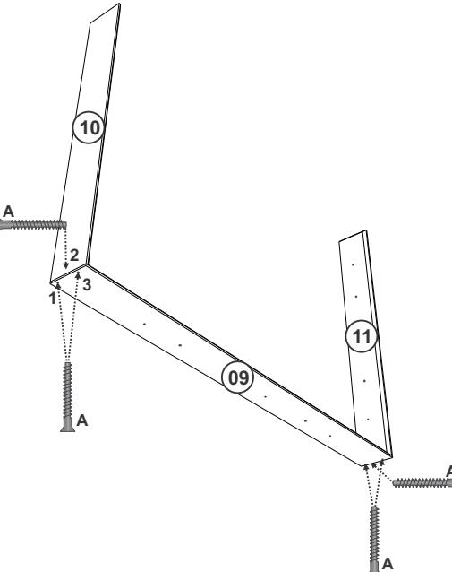
Fixar as peças 10 e 11 na peça 09 com Parafuso 5x40.
