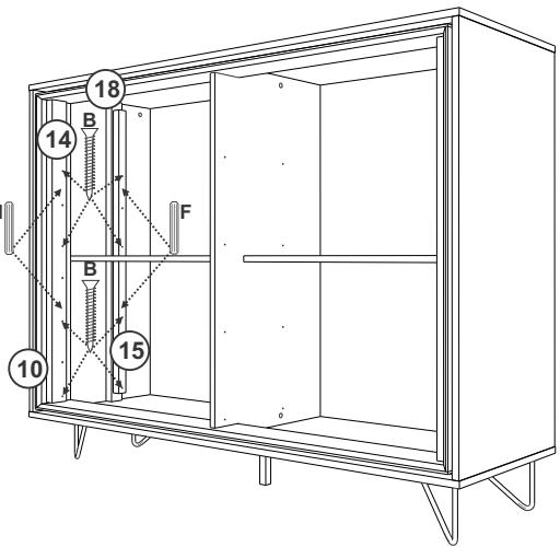
Fixar a peça 14 na peça 10 com Cavilha 6x20 e Parafuso 3,5x35.
