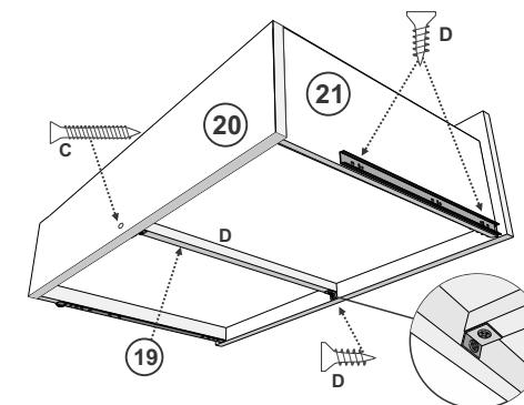
**Atenção:** Para maior resistência da gaveta colocar a trava de gaveta 19 fixada com 1 parafuso 3,5/25 do lado do Contra fundo, e do lado da frente gaveta fixar com a cantoneira metálica e 2 parafusos 3,5/12 .
