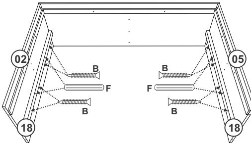
Fixar as peças 18 nas peças 02 e 05 com Parafuso 3,5x35 e Cavilha 6X50.
