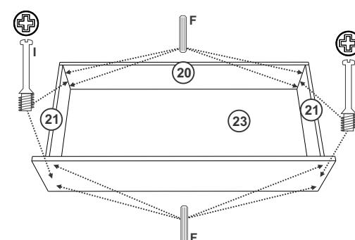
Montar a gaveta com Trapézio e Caviglia conforme ilustração a cima. Fixar a Corredíça rente as laterais 21 com Parafuso 3,5x12 chato.
