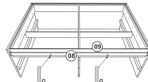
Fixar a peça 08 na peça 09 com Cavilha 6x30.
