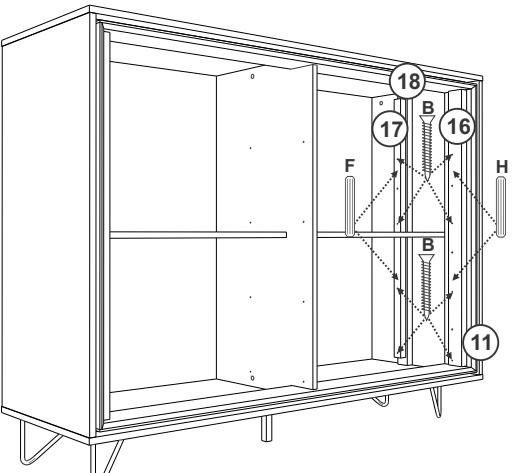
Fixar a peça 16 na peça 11 com Cavilha 6x20 e Parafuso 3,5x35.
