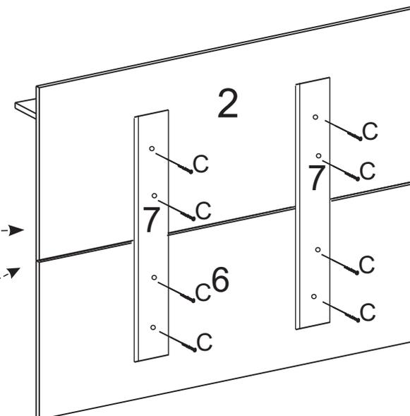
Os parafusos devem ser fixados da frente para traz, para que o painel seja fixado na parede.
