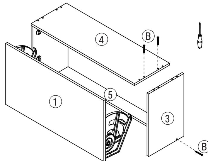
4°. Fixe o tampo ④ na lateral esquerda ② com os parafusos ①B. E a base ⑤ com as cavilhas ①E e o parafuso ①B.
